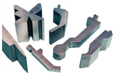
Figura 3 - Perfis diversos das ferramentas de dobramento
